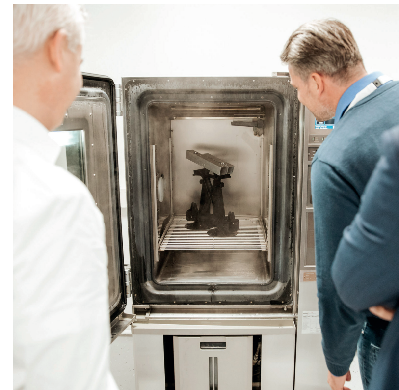
Klimaatkast voor het testen van het FlatFix montagesysteem bij verschillende weersomstandigheden.
