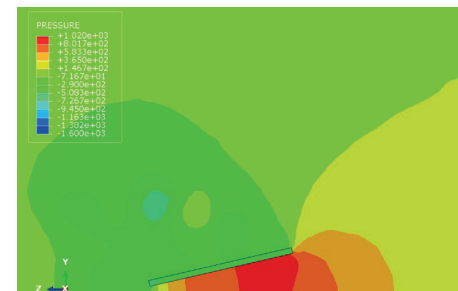
Drukverdeling zonnepanelen zonder zij- en achterplaten op een plat dak.
