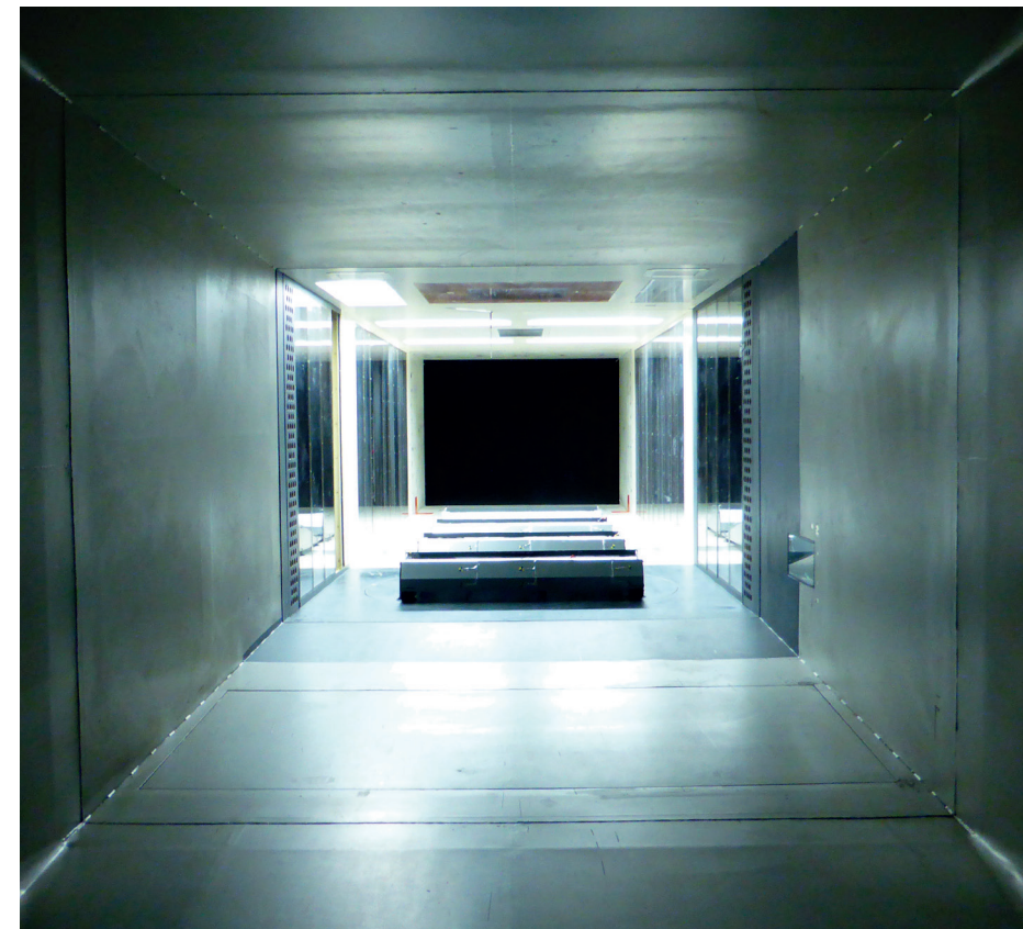
De windtesten op het systeem hebben aangetoond dat de aerodynamica van FlatFix ervoor zorgt dat de wind geen grip krijgt op het paneel. Hierdoor wordt een ongewenst krachterspel voorkomen, waardoor de panelen goed in het systeem blijven liggen.
