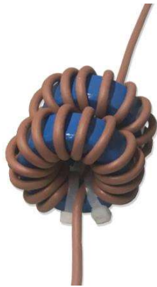
Afbeelding 6: gemonteerde ferrietringen op een fasekabel met een smalle kern
