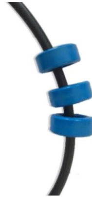
Afbeelding 7: meerdere ferrietringen gemonteerd op een kabel met een bredere kern
